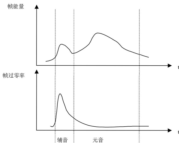
• 经过平滑化处理后的能量曲线轮廓中，有一些谷点处于过渡音段处，而且谷点与左右峰点的幅度差并不大。
