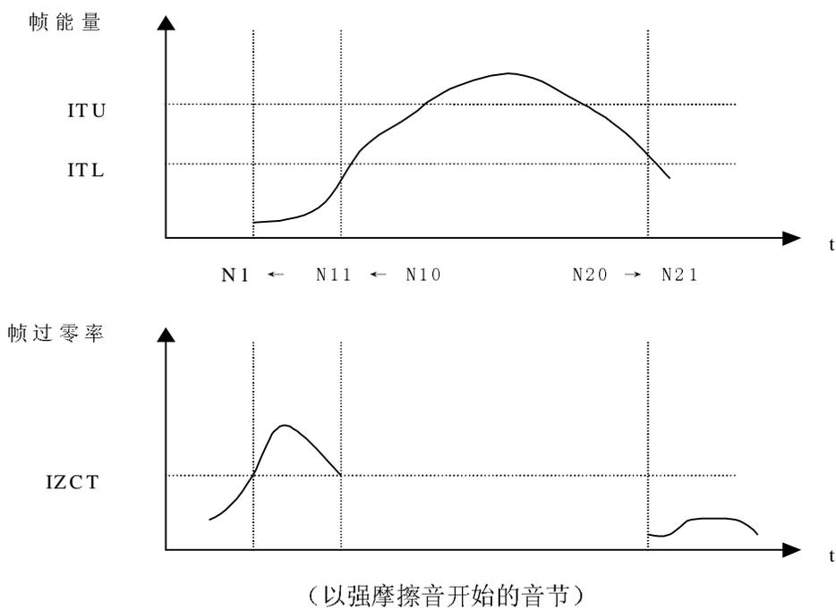
它在能量曲线轮廓中，先以一个很保守的门限 ITU 把音节定位在 N10 与 N20 之间；再从这两个分隔点开始，分别向左右扩张，以另一门限 ITL 把音节定位在 N11 与 N21 之间，最后在平均过零率曲线轮廓中，根据门限 IZCT 分别从 N11 向左或从 N21 向右找到真正的音节起止点 N1 和 N21。这种方法能较好地切分音节，但它有一个很致命的弱点，就是对语音信号的幅度（影响能量轮廓）很敏感，这是因为 ITU 和 ITL 是固定的值。
