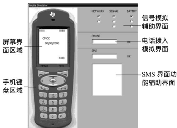
图3 touch 机制下的模拟器
