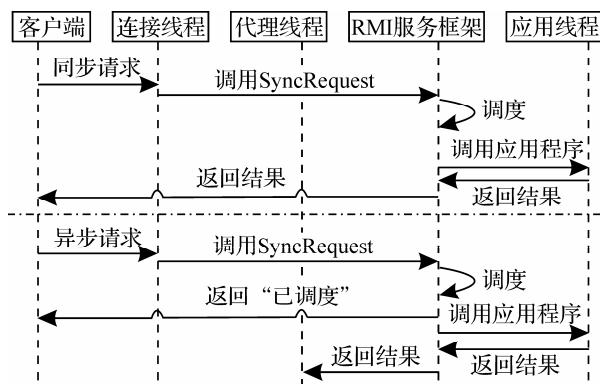
图 1 一个简单的 Java RMI 框架的请求处理流程
