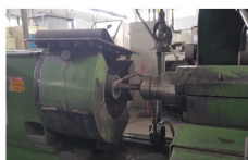
超声振动内圆磨削现场
