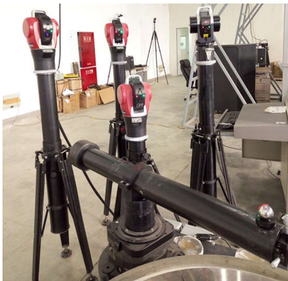
四台激光跟踪仪标定摆臂式轮廓仪旋转轴空间状态
