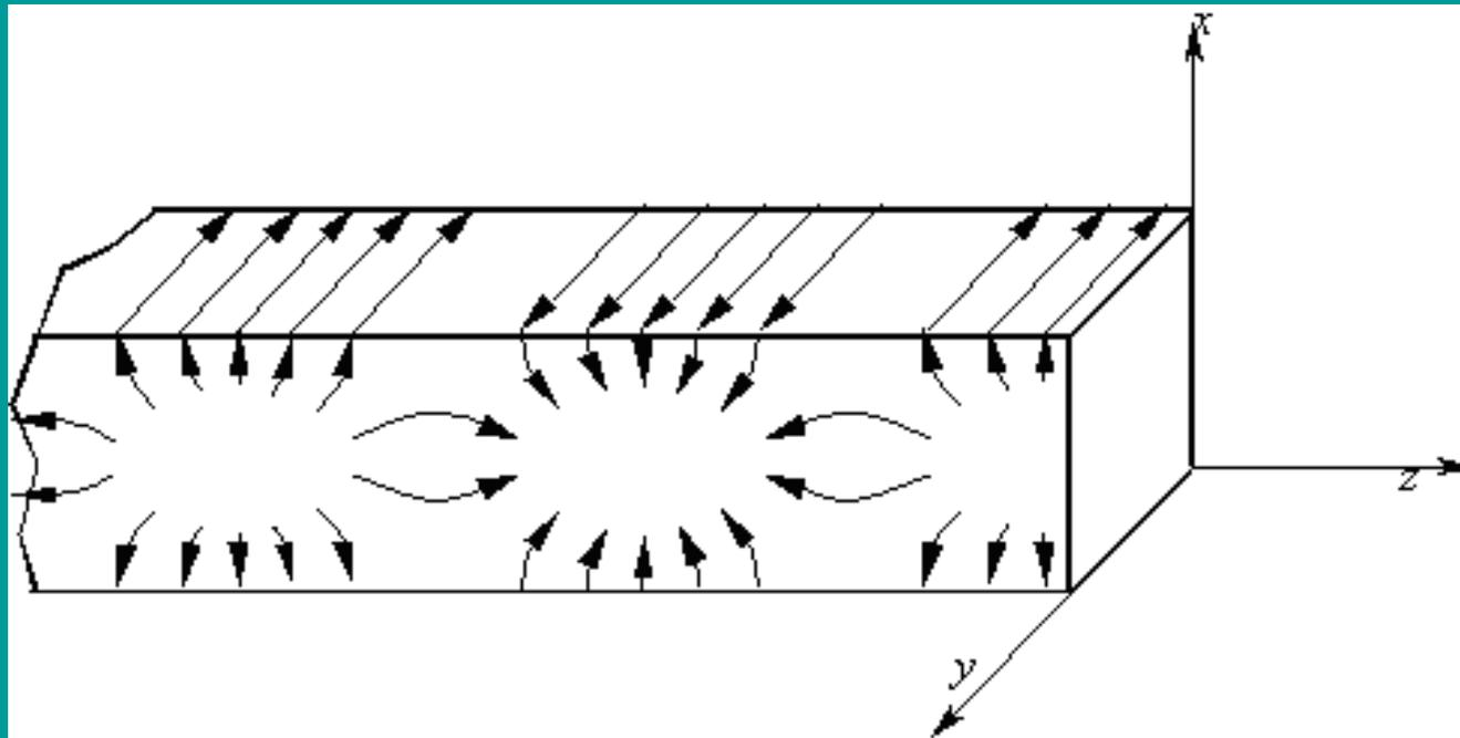
在波导宽边中线上，横向电流为零。因此，开在波导宽边中部的纵向裂缝不会影响TE<sub>10</sub>波的传播
