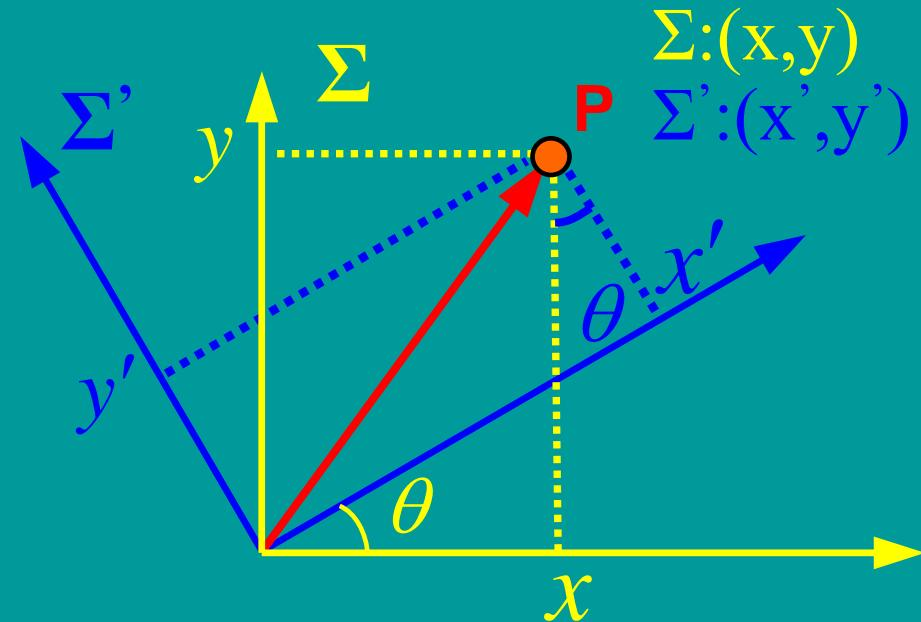
正交变换：距离保持不变的二维平面上的线性变换
