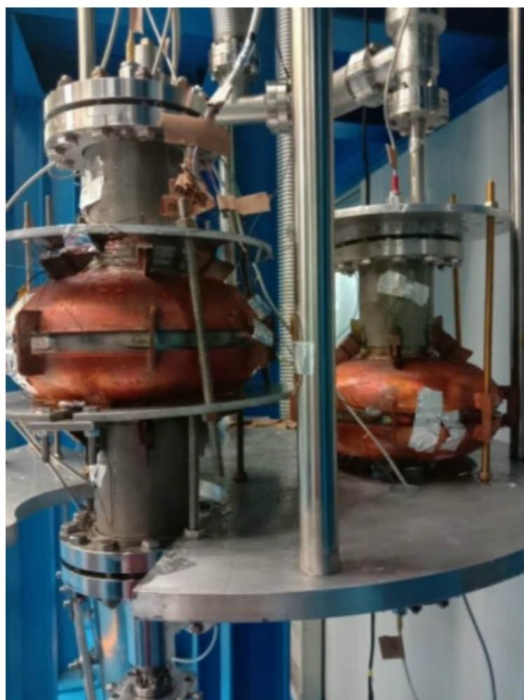
图1: 1.3GHz单cell铜铌复合超导腔
