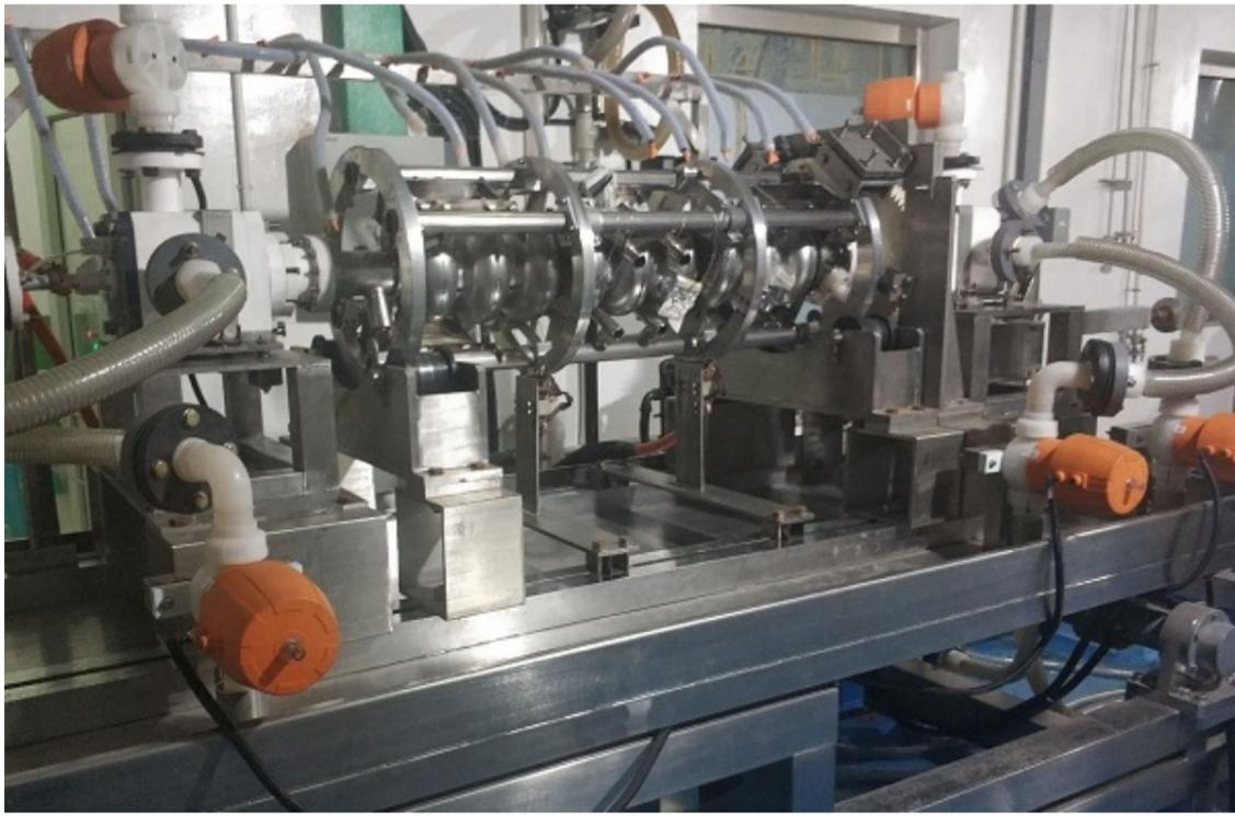
1.3 GHz 9-cell超导腔做电抛光处理
