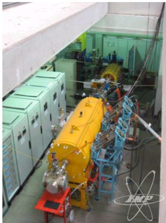
重离子连续波四杆型RFQ测试现场
