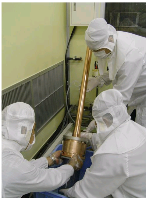
正在进行耦合器测试前的清洗工作
