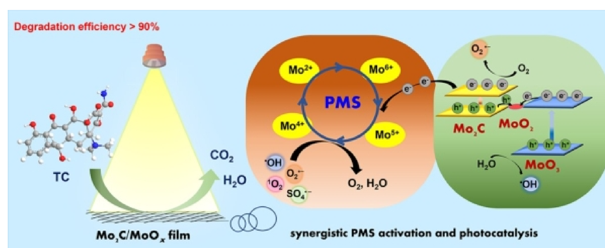
图2. 新型钼基纳米异质结构光催化/PMS氧化偶联体系
