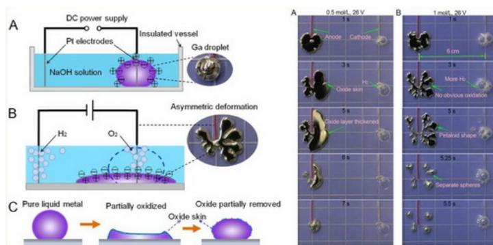
图为基于SCHEME原理的液态金属在NaOH溶液中的可逆变形机制与响应行为
