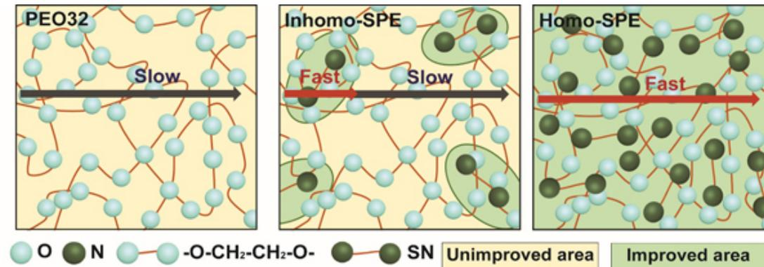
图2 固态电解质锂离子传输模式示意图
