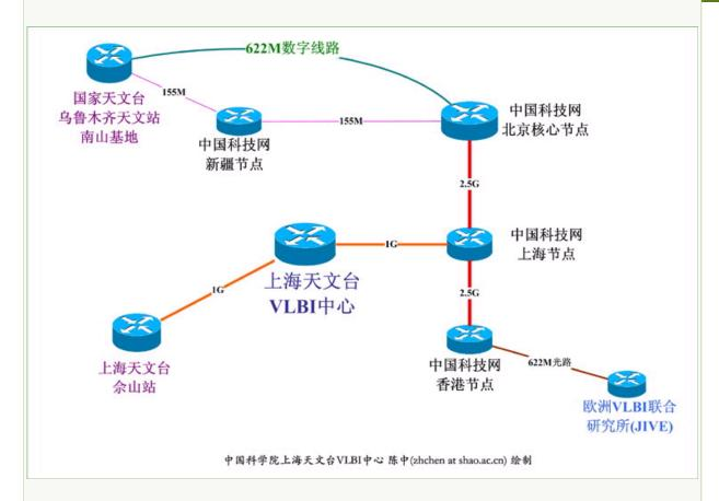
2009年1月6日,中国VLBI网(CVN)的上海天文台佘山站、国家天文台乌鲁木齐南山站,通过中国科技网并利用自行研制的高速软件相关处理机进行了我国首次速度为256Mbps/站的高速实时VLBI(e-VLBI)实验,获得圆满成功。这标志着CVN的e-VLBI能力已经跨上了一个新的台阶。
