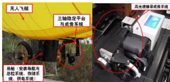
自主开发的无人飞艇多载荷集成遥感监测系统(高光谱+高分CCD+视频+POS)
