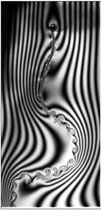
张俊教授发表的细丝在肥皂膜中运动的实验测得的涡量图
