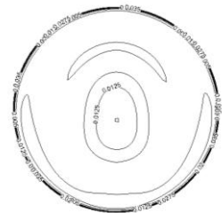
图 12 支撑⑤底部压力分布
