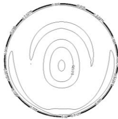
图 11 支撑③底部压力分布
