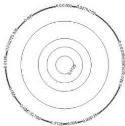
图 10 无支撑底部压力分布
