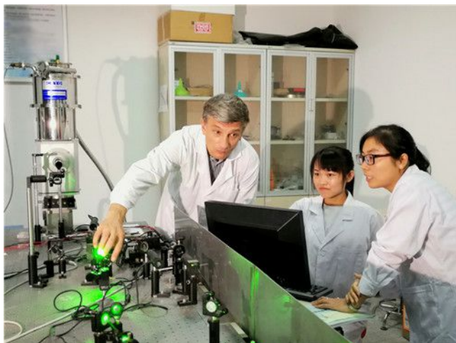
图2. Eugene Gregoryanz (左一) 和刘晓迪 (右一) 等正在进行氢的高压低温拉曼光谱测量
