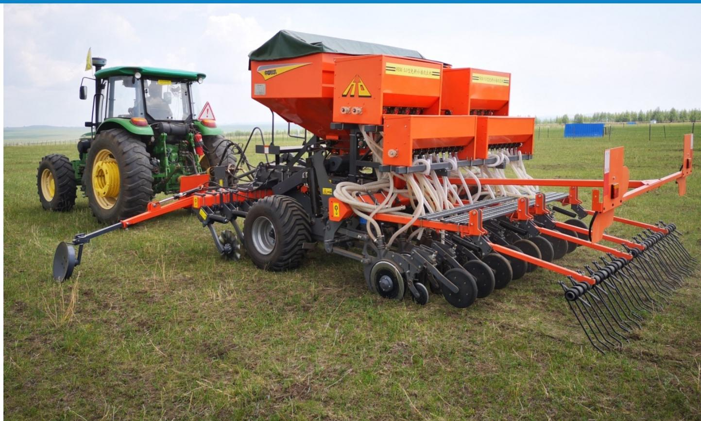
9BM-3.0型免耕补播改良机一次作业可以实现禾本科、豆科等多品种牧草的同行混播、隔行混播作业。适用于退化草原播种、施肥改良作业，是草原生态修复生产力提升的关键装备。在西藏自治区林芝市、新疆维吾尔自治区特克斯市等全国10个试验示范点示范效果良好，丰富了草原草类的多样性，增加了优质牧草的比例，产草量增加50%~150%。
