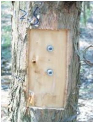
图 1 桉树生长应变测量 1
