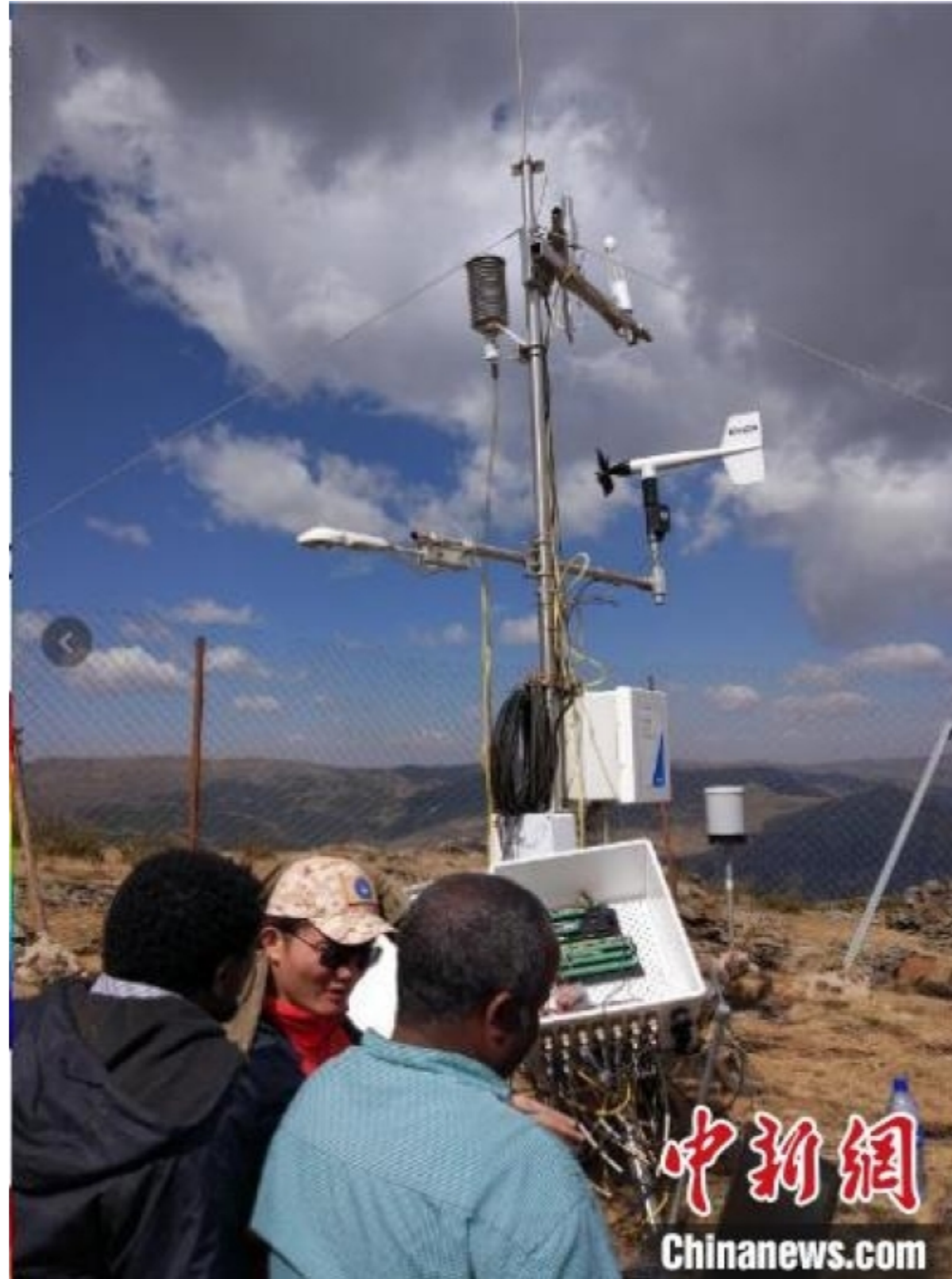
中科院青藏高原所地气作用与气候效应团队在埃塞俄比亚4200米的Choke山上架设涡动相关地表能量平衡系。中科院青藏高原所供图
