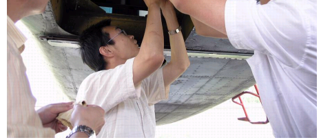
技术人员在飞机腹部安装大幅面数字航摄仪
