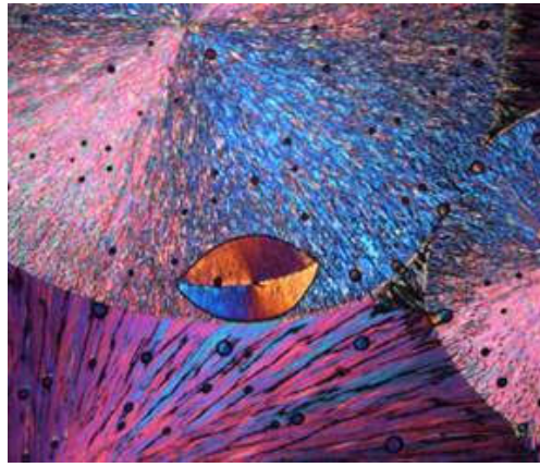
图3. 聚氧乙烯/尿素包合物的亚稳态球晶的晶型转化过程。图中元宝形晶体是亚稳态晶型转变形成的稳态晶型。
