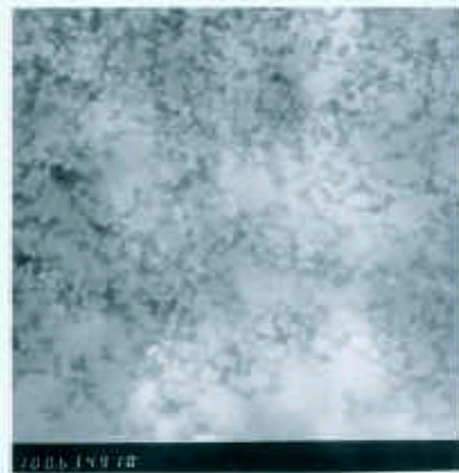
图1. Ni-C纳米粉的TEM像
