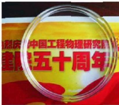
图 1 透明聚氨酯灌封胶照片
