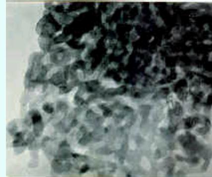
2. 成功地把纳米氧化锆和纳米氧化铝第二相引入快离子导体Li<sub>2</sub>SO<sub>4</sub>和LiNaSO<sub>4</sub>中降低了相变温度，提高了离子电导率，对开发中温燃料电池有重大的意义。
