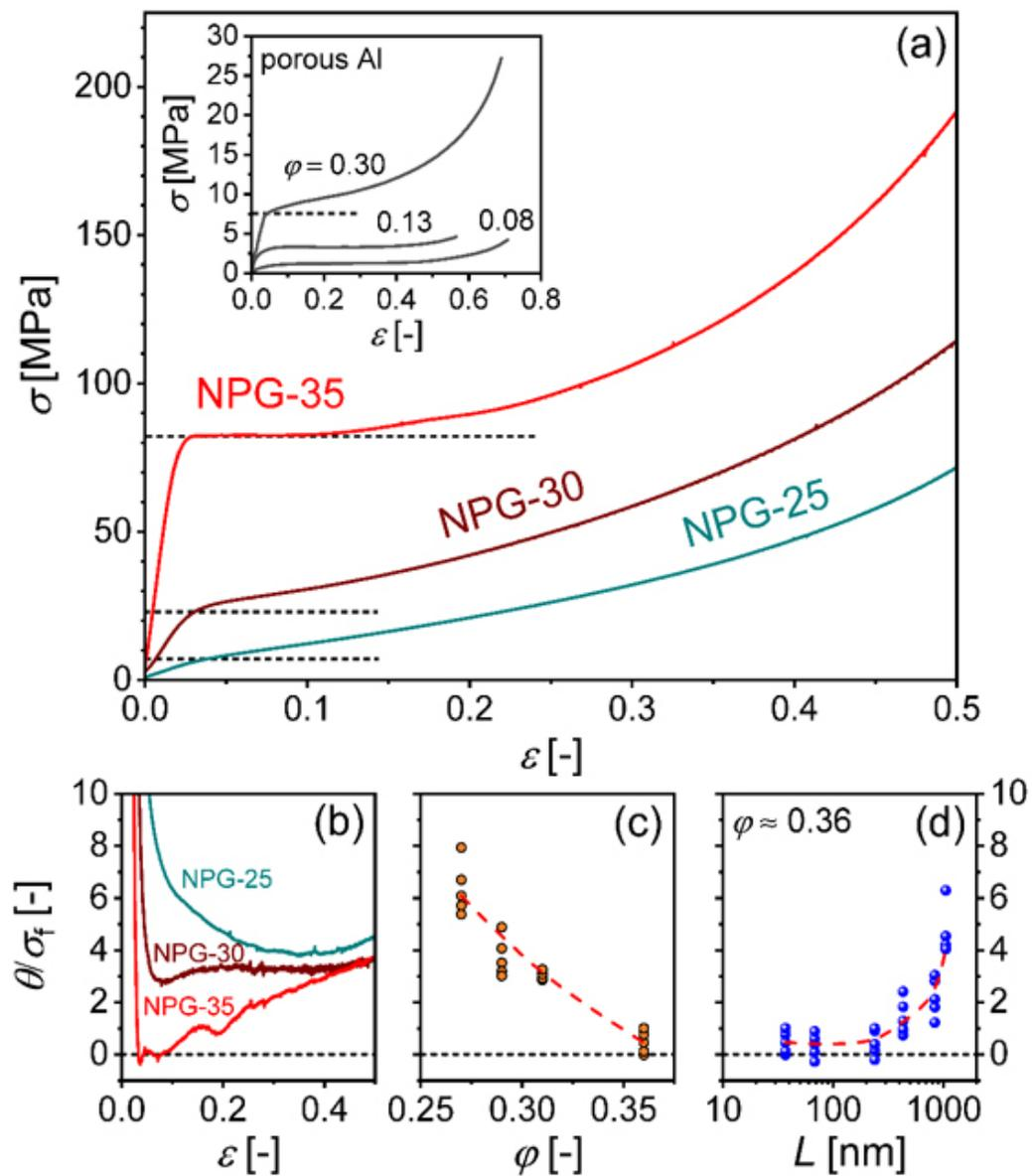
图1. 纳米多孔金的压缩变形行为。(a) 不同相对密度纳米多孔金的压缩应力应变曲线。小图为不同相对密度常规多孔铝的压缩应力应变曲线。(b) 不同相对密度纳米多孔金归一化后的加工硬化率随压缩应变的变化情况。(c) 纳米多孔金归一化加工硬化率随相对密度的变化。(d) 相对密度为0.36的NPG-35样品的加工硬化率随孔棱尺寸的变化情况。
