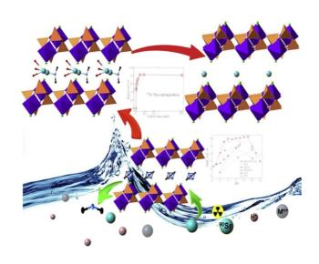
新型二维层状磷酸锆材料通过离子交换选择性吸附污染海水中的放射性90锶 苏州大学供图
