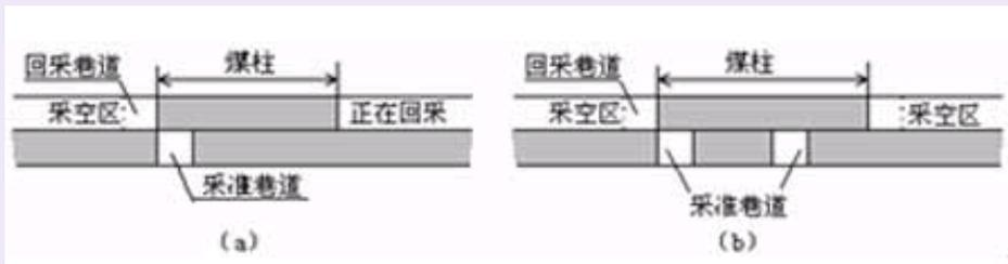
图4 分层开采采掘巷道布置示意图
