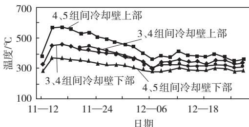
图3 风口喂钛线后炉缸2层侧壁温度下降情况
