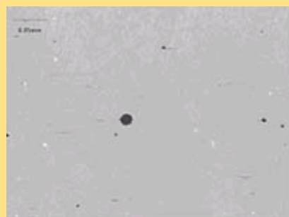
图2 球化的D类夹杂物
