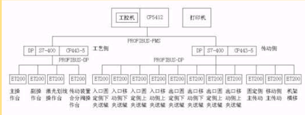
图3基础自动化系统硬件配置
