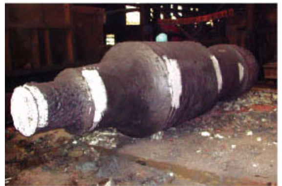
通过计算机模拟设计铸造工艺，在一重实现了50吨铸钢支撑辊的浇注
