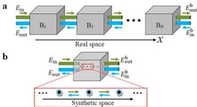
全光器件的设计原理示意图。a) 传统的全光器件是基于光子在真实空间中的传播和干涉，需精密地调控大量光学原件。b) 利用光子在人工维度上的传播和干涉来设计新型的全光器件。
