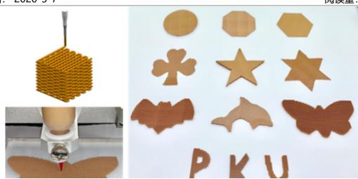
北京大学、南方科技大学和济南大学的研究人员最近设计了一种陶瓷 - 聚合物复合材料,可以用于打印复杂的三维网格结构。该复合材料首次发表在《纳米能源》杂志上的一篇论文中,具有许多理想特性,包括高柔韧性和高机电能量转化率。
