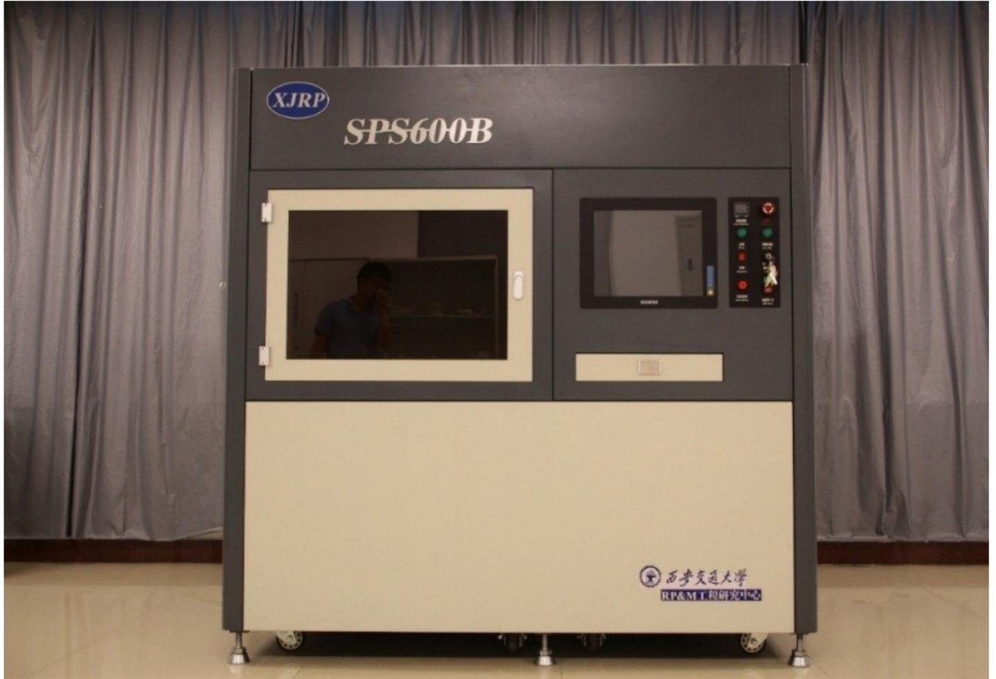
中文名称: 激光SPS600B光固化3D打印机
