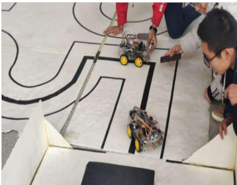
决赛内容比初赛增加了侧方停车和RGB指示灯控制部分，参赛队需要在比赛开始前，通过手机控制智能车上的蜂鸣器鸣笛，之后控制小车走完手动控制部分赛道，中途需要作出侧方停车动作。接着，选手需要将智能车切换为自动循迹模式，此时智能车将沿着循迹黑线自动行驶，当小车完成循迹部分时就进入到了自动避障部分，此时小车将通过前端的超声波模块检查前方有无障碍物，判断与障碍物的距离从而作出相应的避障动作。智能车切换模式时，RGB指示灯也随之变化。最后，经评委打分，共评选出一等奖2项，二等奖4项，三等奖6项。
