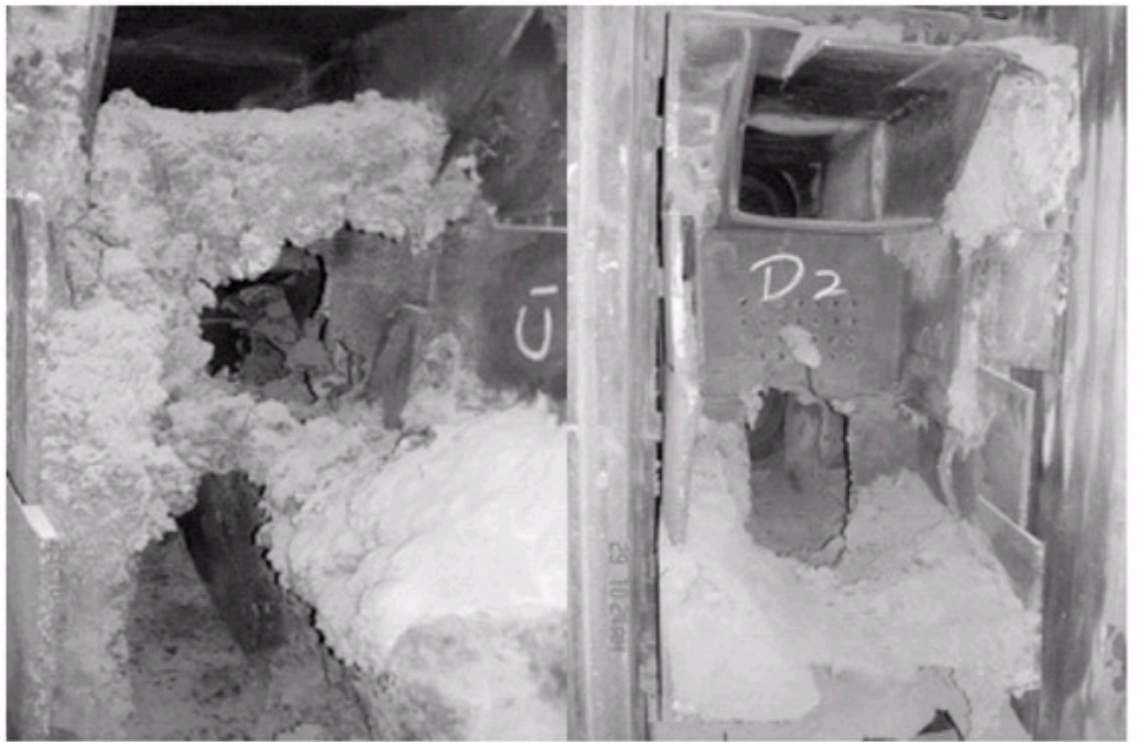
图2 烧损的C1、D2煤粉燃烧器
