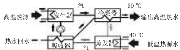
图1 第一类吸收式热泵的工作原理
