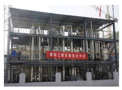
日前,中科院山西煤炭化学研究所610课题组开发的醋酸加氢合成乙醇技术成功在小店基地完成中试并实现平稳 运行,实现了催化剂与工艺的全面验证。这一中试项目规模为50吨/年,采用工业型非贵金属催化剂,醋酸转化率 >99.8%, 乙醇选择性>99.5%。醋酸加氢合成乙醇是煤经甲醇、醋酸制乙醇技术的核心单元,技术中试的完成,标志 着山西煤化所煤制乙醇技术取得重大突破。
