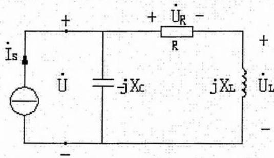
六、元件参数及  $\dot{U}_1$  已知, 求 1-1' 之间的开路电压  $\dot{U}_K$  和等效阻抗  $Z_{eq}$  (15 分)
