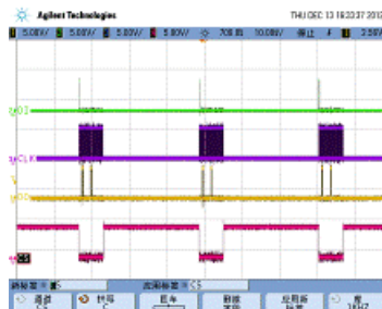
图3 电池数据信息读出波形(图3为芯片读取的电池电压等信息,该数据通过SPI接口上传给MCU并计算得出电池电压等信息的精确结果。)
