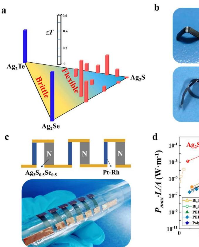
a)  $\text{Ag}_2\text{S}-\text{Ag}_2\text{Se}-\text{Ag}_2\text{Te}$ 体系的“塑性- $zT$ ”相图。b)  $\text{Ag}_2\text{S}$ 基柔性热电材料的优异力学性能和其它已报道的柔性热电器件的功率密度对比。
