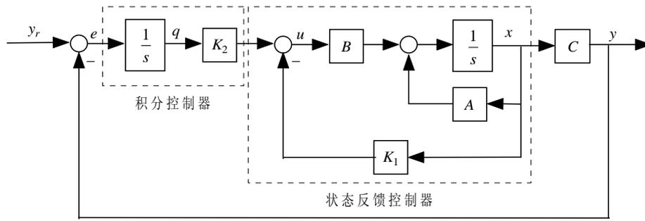
构建增广系统，通过极点配置方法来设计增广系统的状态反馈控制器，从而使得闭环系统不仅保持期望的动态性能，而且避免了稳态误差的出现。
