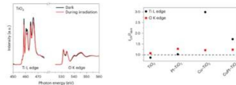
左图: TiO<sub>2</sub>在黑暗和辐照条件下的Ti L边和O K边NEXAFS光谱; 右图: 辐照条件下改性样品中Ti L边和O K边强度与黑暗条件下的比值。
