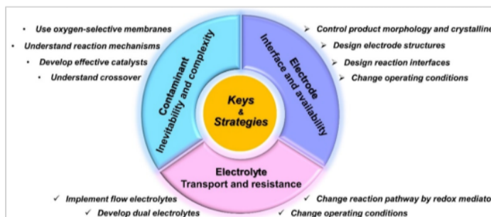
图2 非水系锂-空气电池的关键传质问题与解决策略
