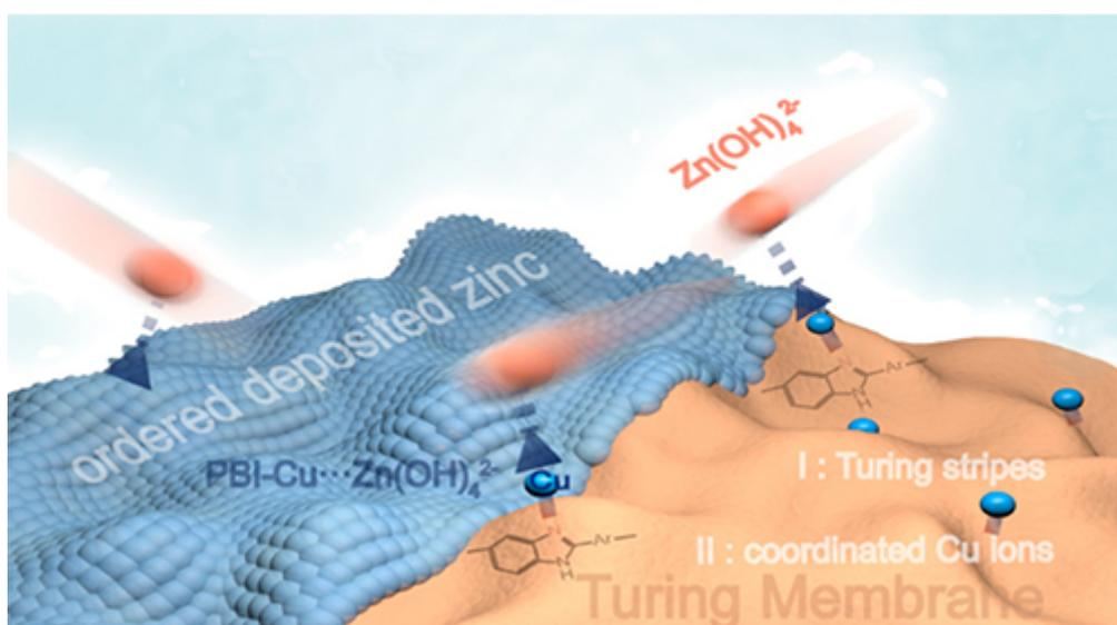
可再生能源的快速发展，推动了以锌化学为基础的高能量密度储能器件的开发和研究。锌二次电池具有成本低，安全性高，能量密度高，且与水性电解质具有良好的相容性等优势，在电化学储能领域具有很好的应用前景。然而，锌在沉积过程中容易产生锌枝晶，在高面容量和高电流密度的工作条件下更为严重，影响电池的循环寿命。
