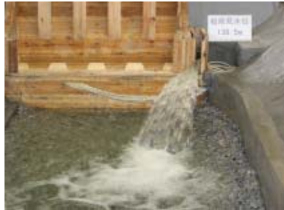
照片 2 推荐方案放水底孔挑射水舌
