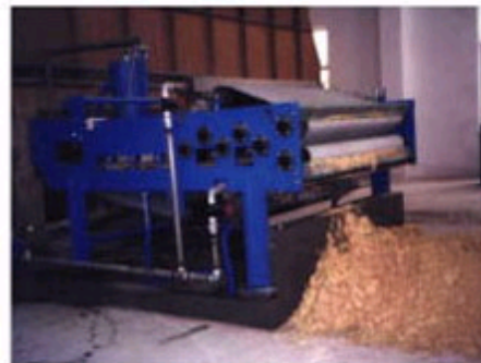
压滤机正在进行泥水分离
